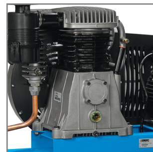
Špičkový 2stupňový kompresor s mezichladičem a olejoznakem.
